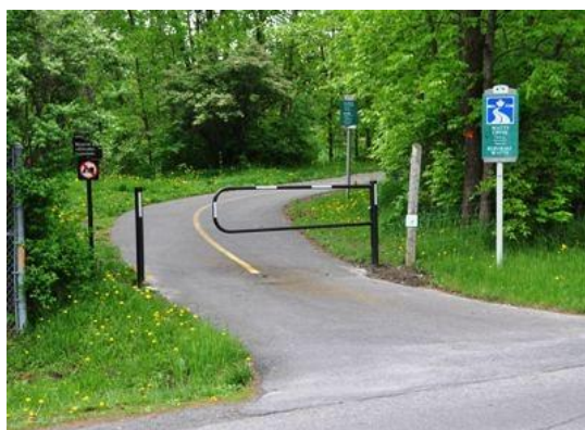
Obrázok 54 Cyklistická zábrana – brána (príklad realizácie)
