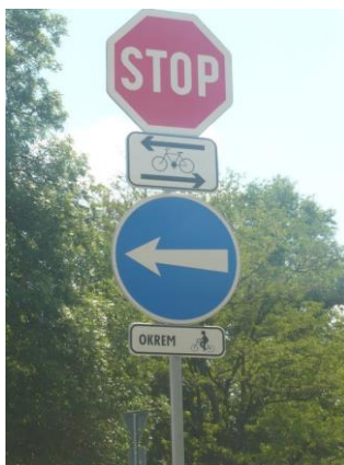
Obrázok 65 Príklad realizácie dopravného značenia pre priečnu jazdu bicyklov
