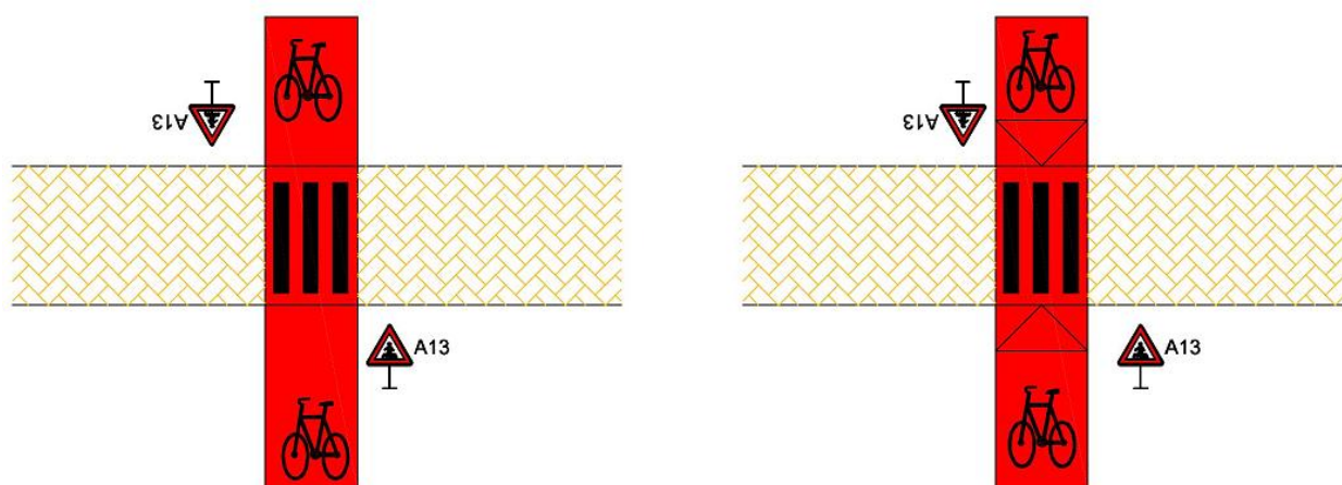
Obr. 4.5.5.-3 Kríženie cyklistických pruhov s chodníkmi
