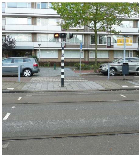
Obrázok č. 20: križovatka s električkovou traťou, kde sú nainštalované „električkové svetlá“
