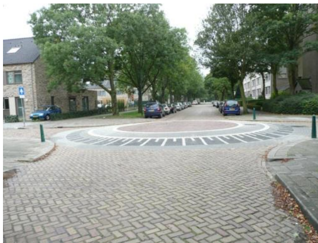
Obrázok č. 17: križovatka 2 lokálnych prístupových ciest, kde sa použil princíp rovnosti (medzi cyklistami a motoristami)
