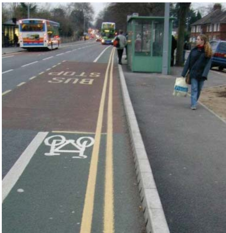
Obrázok č. 37: príklad zastávky autobusov v cyklo pruhu vo Veľkej Británii (zdroj: Cycling England)
