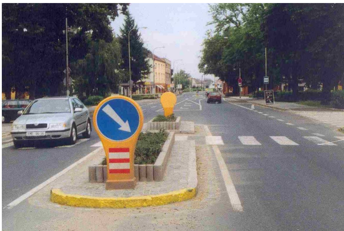
Obr. 7.32 Zúženie jazdného pruhu deliacim ostrovčekom
