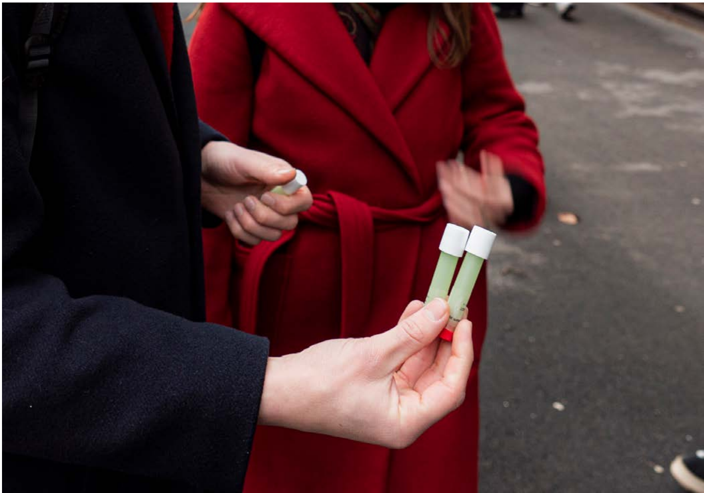
Obr. 11: Pasívny vzorkovač na meranie koncentrácie NO 2
